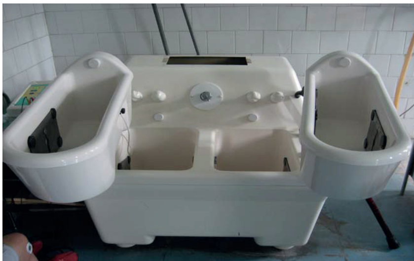
Fig. 19. Banja katërçelulare (me katër ndarje) për galvanoterapi
